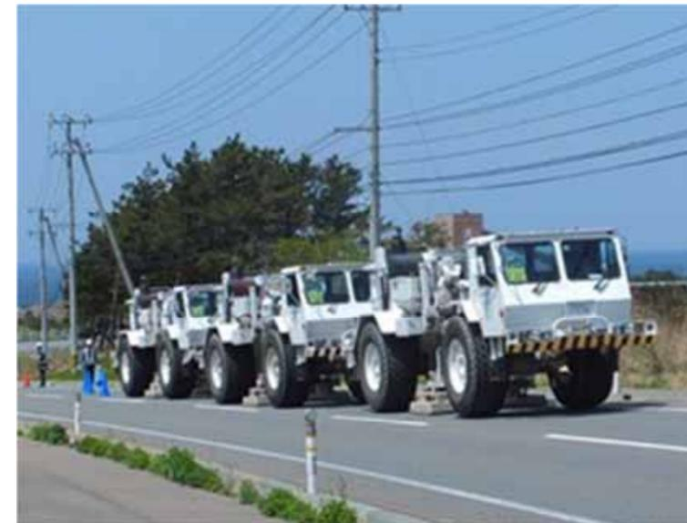
図4 弾性波探査の調査の状況(事例)
