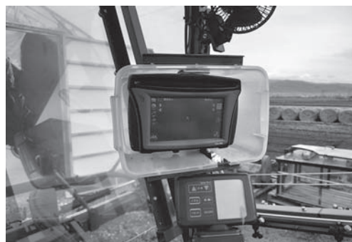
GPSを搭載した防除機
