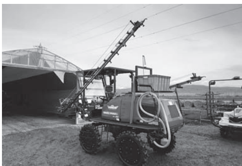
GPSを搭載した防除機
